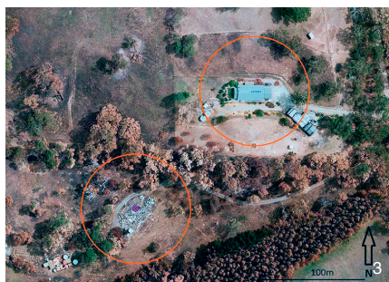
3 照片来自澳大利亚新南威尔士政府，展示了山火后的 2 处住宅。图中左下的住宅被树林紧密围合，山火轻易地蔓延并烧毁了建筑。图中右上的住宅则因周边空旷而未受影响。在有山火风险的地区，分隔建筑和荒野地、分隔社区和荒野地是基本的设计原则
